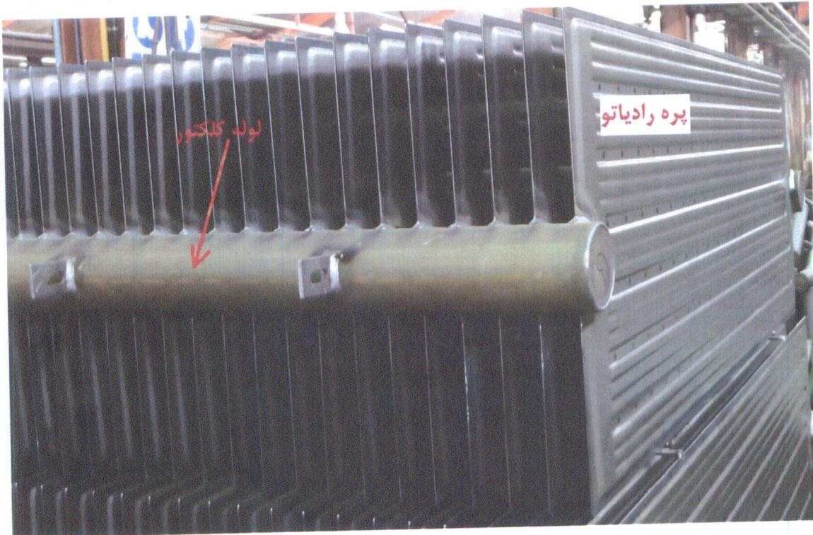
تصویری از یک بلوک کامل ( تعدادی پره رادیاتور به یک لوله جوش شده اند)
